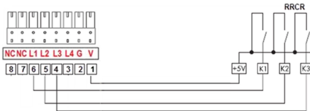
Abbildung 5 – Wechselrichter – FRE Verbindung (mit 3 Relais)
