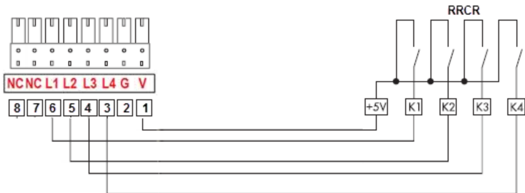
Abbildung 2 - Wechselrichter - FRE – Verbindung (mit 4 Relais)
