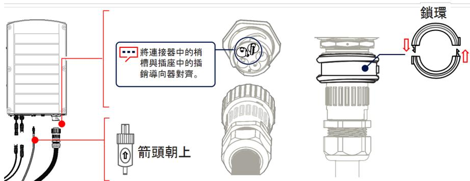
圖 12: 變流器裝置 - 底部和側面界面
