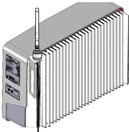
図3：アンテナケーブルの配線
