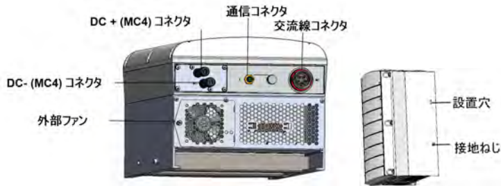
図 13: セカンダリユニット下部および側面 インターフェース
