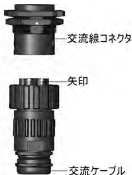
図 19: 交流コネクタのセカンダリユニットへの接続
